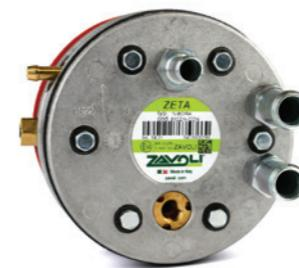
Reducitor-vaporizator cu diafragmă de presiune pozitivă cu un singur treapta, compensat cu schimbător de căldură apă-gaz, supă internă de suprapresiune. Este disponibil în două versiuni, ZETA N (normal) și ZETA S (super). Reductorul este foarte compact cu dimensiuni limitate.
